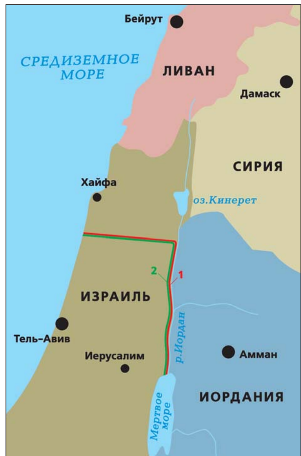
Рис.3. Схема предлагаемого двухпоточного водовода: 1 — опресненная вода; 2 — морская.
