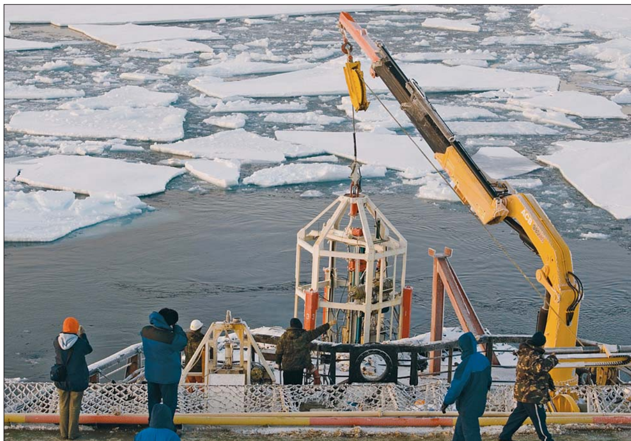
Опускание буровой установки с борта ледокола.
